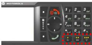
Abbildung 5 Funktionstasten der MRT
